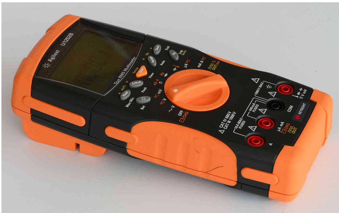
Rys. 1.5: Widok płyty czołowej multimetru ręcznego U1252B
